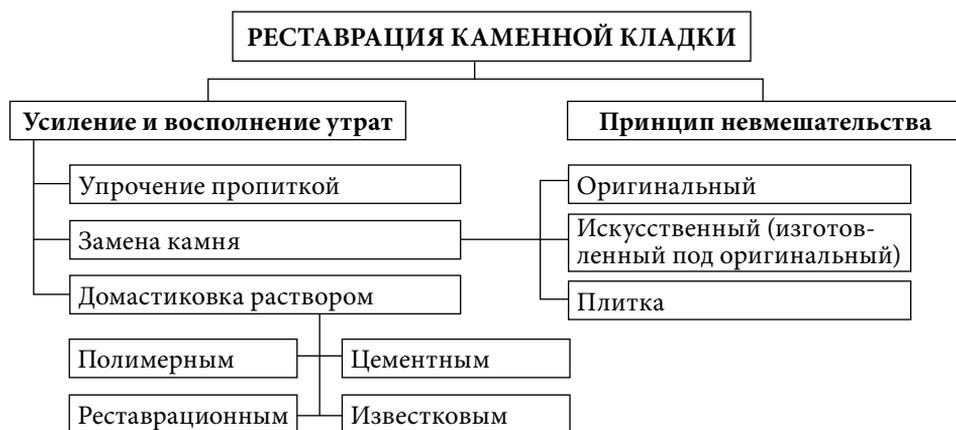
Схема 1. Схематическое представление принципов и способов реставрации каменной и кирпичной кладки
